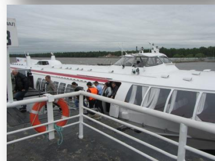
Obrázek 3: Nejrychlejší spojení centra Petrohradu s Petrodvorcem zajišťují lodě na nosných křídlech řady Meteor, podobné lodě jsou provozovány v Bratislavě, dosahují rychlosti kolem 60 km/h
