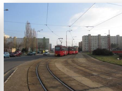
Obrázek 17: Smyčkové obratiště tramvají v ose vozovky v Bratislavě
