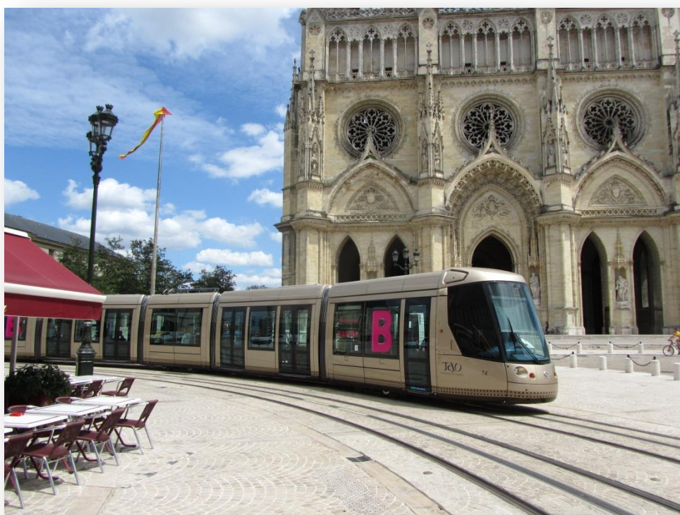
Obrázek 31: Napájení tramvaje ze spodní napájecí kolejnice nevyžaduje instalaci trolejového vedení, je tím městskému prostředí přátelštější: Tramvaj v Orleánsu
