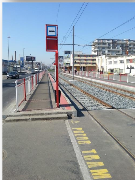
Obrázek 14: Tramvajové zastávky ve středním dělicím pásu (s vyvýšeným nástupištěm, s označníkem a ochranným zábradlím, bez přístřešku)
