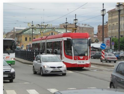
Obrázek 13: Článekové nízkopodlažní tramvaje ruské výroby v Petrohradě (výrobce Vagonmaš Petrohrad)
