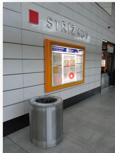
Obrázek 36: Odpadkové koše pražského metra jsou přizpůsobené možnosti teroristického útoku (koše jsou odolné proti výbuchu, výbuch tlumí nebo ho usměrňují ve směru nahoru)
