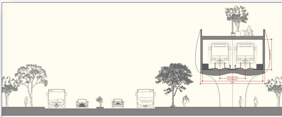
Obrázek 18: Příčný profil úseku metra na estakádě v zakrýtem provedení
