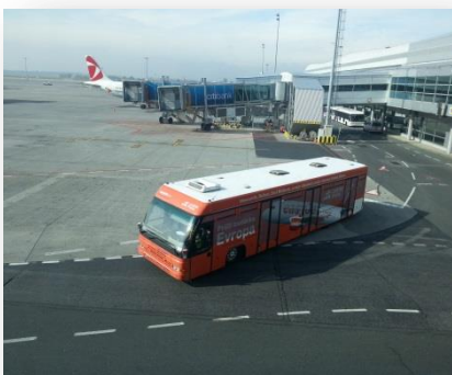
Obrázek 15: Odbavování letadel pomocí nástupních mostů a autobusů na letišti v Praze (odbavovací stojánky s nástupními mosty typu MARS umožňují alternativně odbavit jedno velkokapacitní letadlo, nebo dvě letadla střední kapacity)
