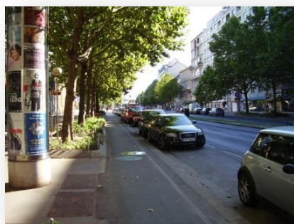
Obrázek 19: Vídeňská varianta cyklistické stezky na chodníku je investičně náročnější (vyžaduje úpravu chodníku), ale je méně nebezpečná pro cyklisty a méně obtěžuje automobilový provoz, neodděluje parkující automobily od provozu na vozovce, vytváří však konfliktní zónu možného střetu osob vystupujících z automobilu a projíždějících cyklistů
