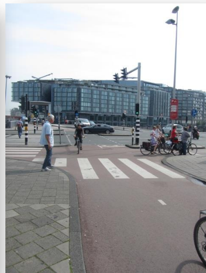
Obrázek 27: Přejezdy na síti cyklistických stezek v Kodani (stezky i přejezdy odděleny od souběžných pěších tras, směrové dělení, světelná signalizace)
