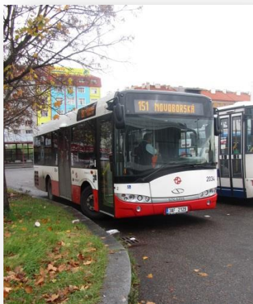
Obrázek 6: Midibus (zkrácená verze autobusu na cca 10 m) na méně zatížených linkách MHD v Praze
