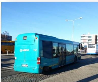
Obrázek 16: Autobus na hybridní diesel-elektrický pohon v Praze (Mercedes) má baterie umístěné v zádí vozidla
